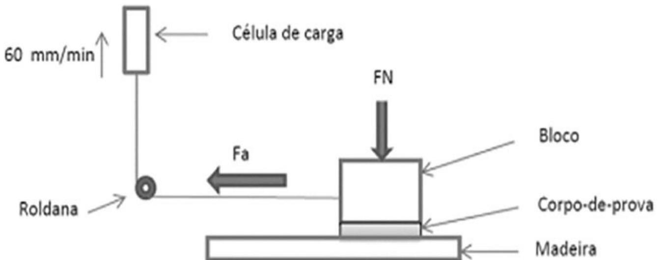
Figura 3 - Esquema para ensaio de determinação de coeficiente de atrito
